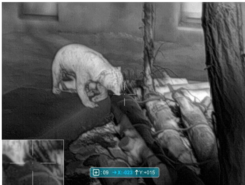
Рис. 15 Интерфейс функции коррекции «битых» пикселей.
