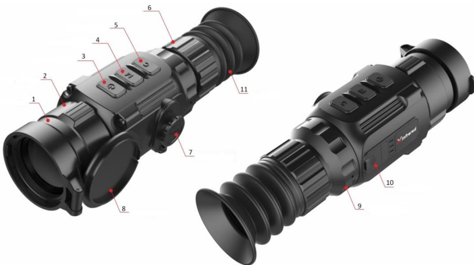
Рис. 2 Устройство прицела SCP19W
