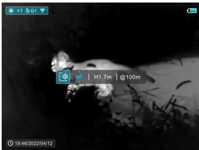
Рис. 14. Меню настройки фиксированного дальномера.
